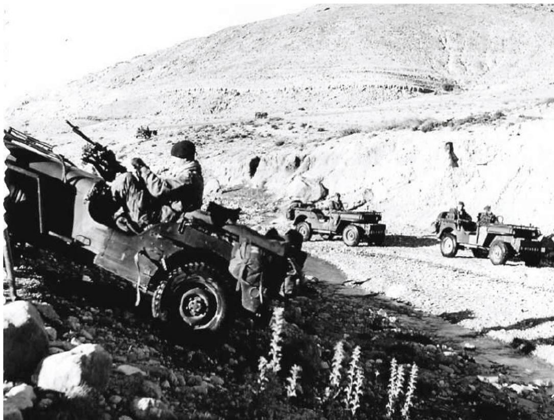
**Progression en tout terrain d'une Jeep M 201 armée d'une mitrailleuse AA 52 sur son support type AFN.
